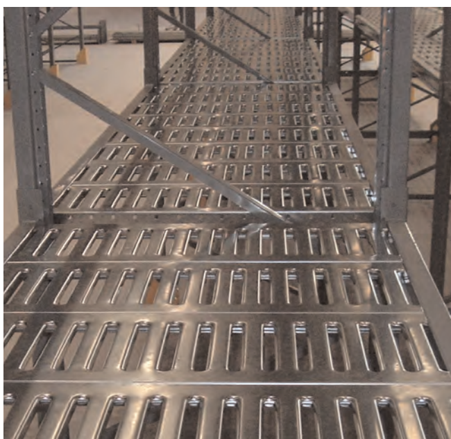
Plancher du rayonnage
